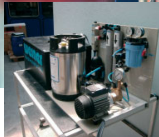
Abb. 1: Zur Versorgung eines Universitäts-Labors wurde eine Laborwasseraufbereitung mit einer Leistung von 20 l/h (Deionat <math><1\ \mu\text{s}</math>) benötigt. Nach der Detailplanung mit dem Kunde und Labormöbelhersteller (Waldner) wurden alle Komponenten für das Einschubmodul werksseitig vorbereitet.
